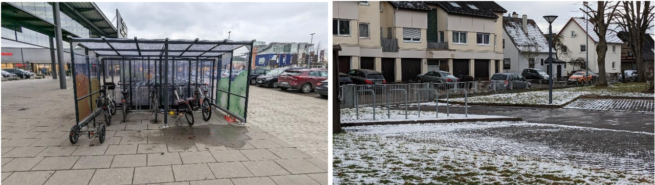
Abbildung 54: Abstellanlagen Typ BETA mit hohen Kapazitäten und wenig Flächenverbrauch (links: Iller-Center Senden) und Anlehnbügel als dezentrale Abstellanlage (rechts: Neuapostolische Kirche Senden)
