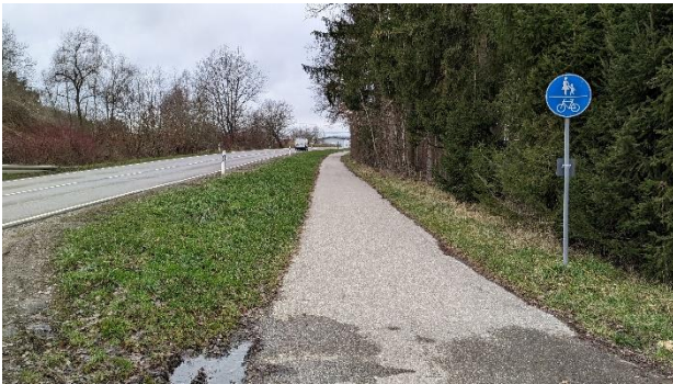
Abbildung 28: Gesicherte Radverkehrsführung: Straßenbegleitender (links) und selbstständig geführter gemeinsamer Geh- und Radweg (rechts)
