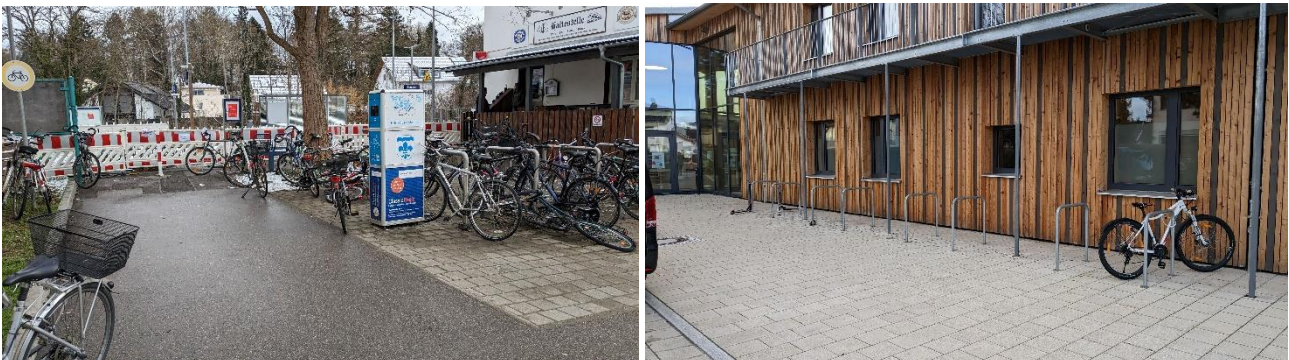
Abbildung 51: Abstellanlagen mit Anlehnbügeln und Ladestation (links am Bahnhof Senden) oder mit Witterungsschutz (rechts am Kindergarten St. Lucia)
